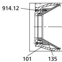
**Рисунок 32:** Демонтаж износозащитной стенки
