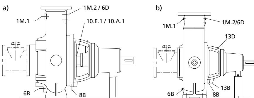
Рисунок 8: Вспомогательные соединения: а) Насос с сальниковый набивкой, б) Насос с торцевым уплотнением
