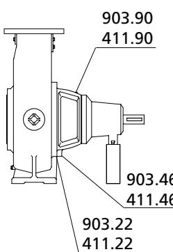
**Рисунок 17:** Спуск смазочной жидкости
