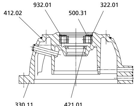
Рисунок 34: Подготовка опоры подшипника
