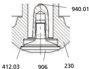
**Рисунок 23:** Демонтаж рабочего колеса
