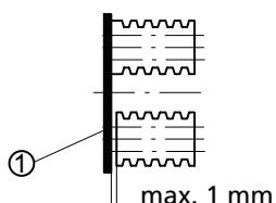
**Рисунок 10:** Проверка ременного шкива
