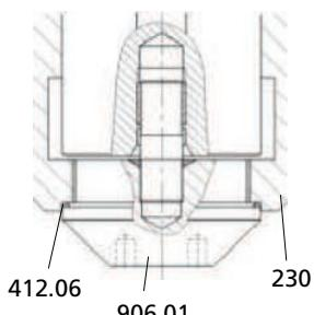
**Рисунок 25:** Демонтаж рабочего колеса
