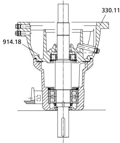
**Рисунок 30:** Отделение опоры подшипника
