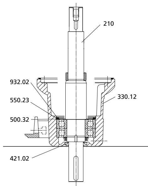
**Рисунок 35:** Монтаж вала
