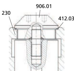
**Рисунок 43:** Установка рабочего колеса
