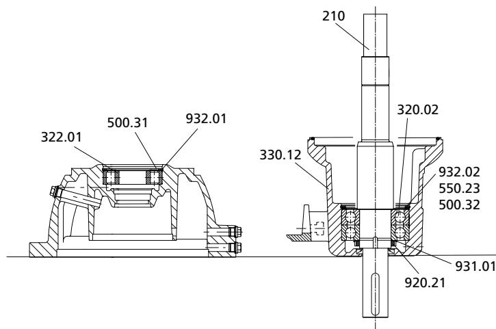
**Рисунок 31:** Демонтируйте вал
