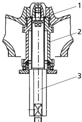
**Рисунок 26:** Съемник
