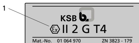
Рисунок 2: Пример: Дополнительная заводская табличка для взрывозащищенных насосов
