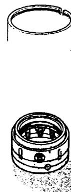
На наружной окружности корпуса (780) находятся два маркировочных желобка. Нижний проходит точно через отверстие винтов с внутренним шестигранником. Это означает, что винты имеют метрическую резьбу.
