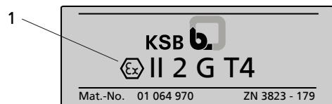
Рисунок 2: Пример: Дополнительная табличка для взрывозащищенных насосов
