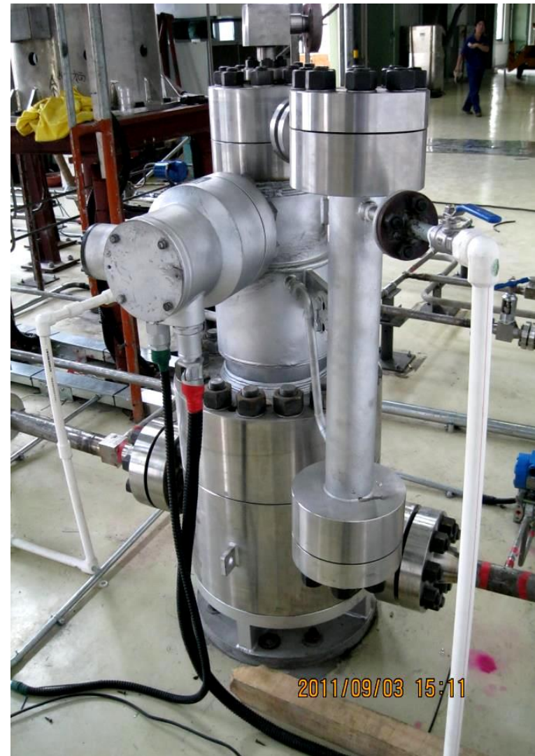
Насос серии НТ на высокое давление и температуру. Атомная станция (КНР)
