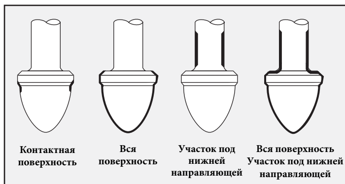
Рисунок 18: Варианты упрочнения поверхностей плунжера
