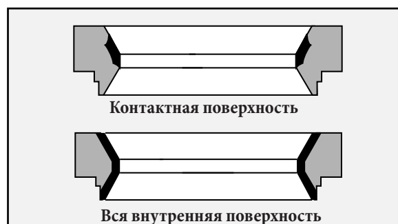
Рисунок 19: Варианты упрочнения поверхности седла
