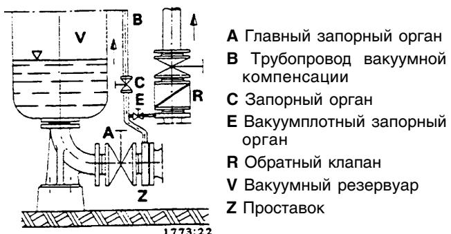
Рис. 3 Всасывающий трубопровод и трубопровод вакуумной компенсации
