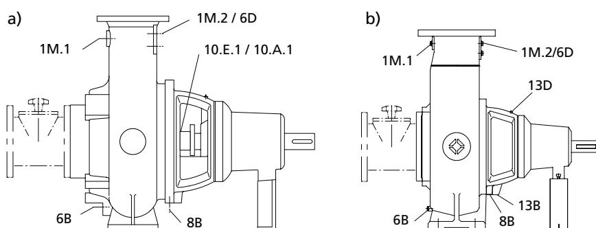
Рисунок 8: Вспомогательные соединения: а) Насос с сальниковым набивкой, б) Насос с торцевым уплотнением
