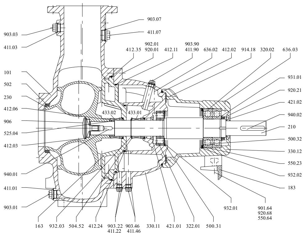
Рисунок 46: Горизонтальная установка, уплотнение вала: Торцевое уплотнение
