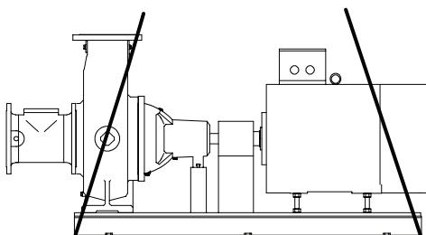
Транспортировка насоса на опорной плите.
