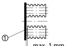
**Рисунок 10:** Проверка ременного шкива
