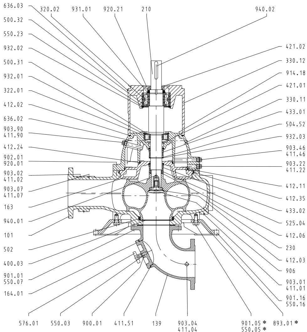
**Рисунок 48:** Насос в исполнении с карданным валом, уплотнение вала: Торцевое уплотнение
