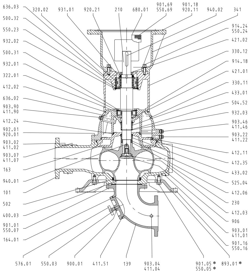
**Рисунок 47:** Насос в исполнении для установки под полом, уплотнение вала:
