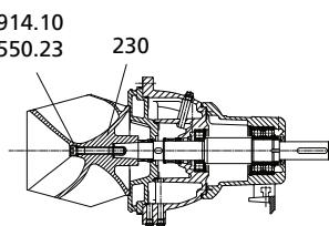
Рисунок 27: Демонтаж рабочего колеса
