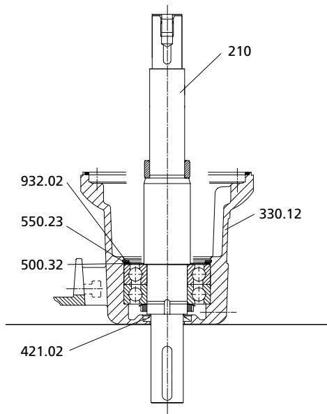
**Рисунок 35:** Монтаж вала
