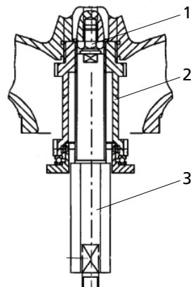
**Рисунок 26:** Съемник
