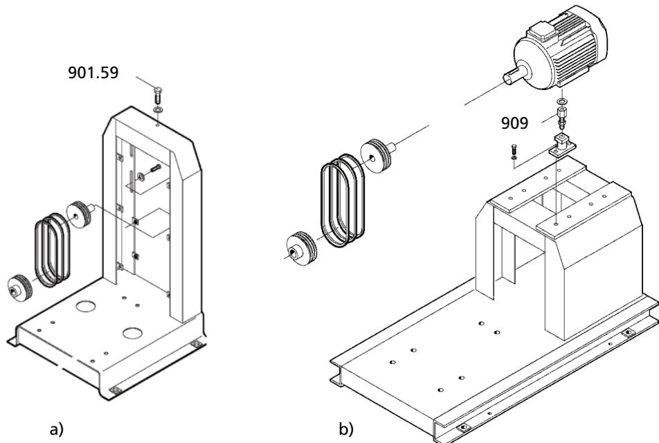
**Рисунок 11:** Натяжение ремня, а) Тип установки 3 HZ, б) Тип установки 3 HM
