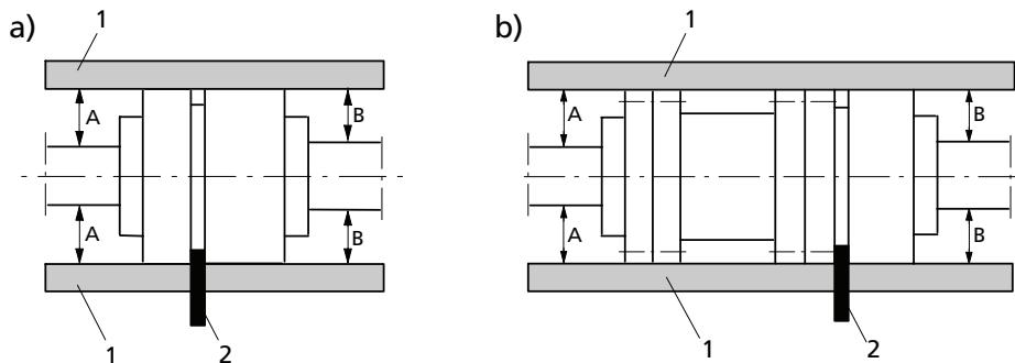
**Рисунок 9:** a) Контроль центровки муфты и b) центровка муфты с проставкой
