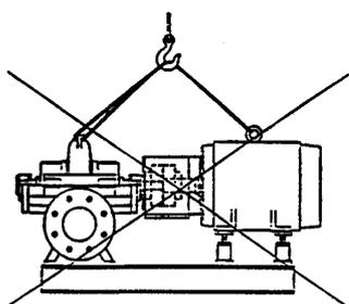
Рис. 3: **Запрещение** транспортировки агрегатов
