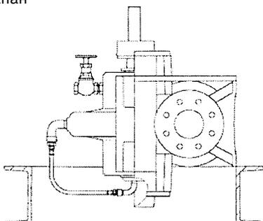
08 Трубопровод промывочной жидкости для торцового уплотнения и подшипника Residur и воздуховыпускной клапан
