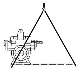
Рис. 4с: Транспортировка насосного агрегата (без двигателя)
