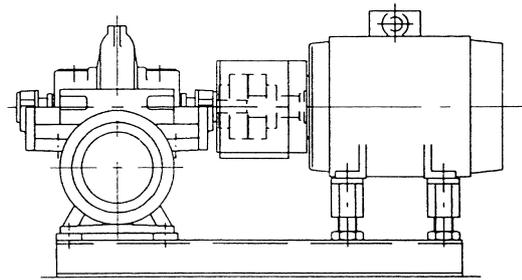
Насосный агрегат с непосредственно присоединенным двигателем (монтажная форма IM B3)
