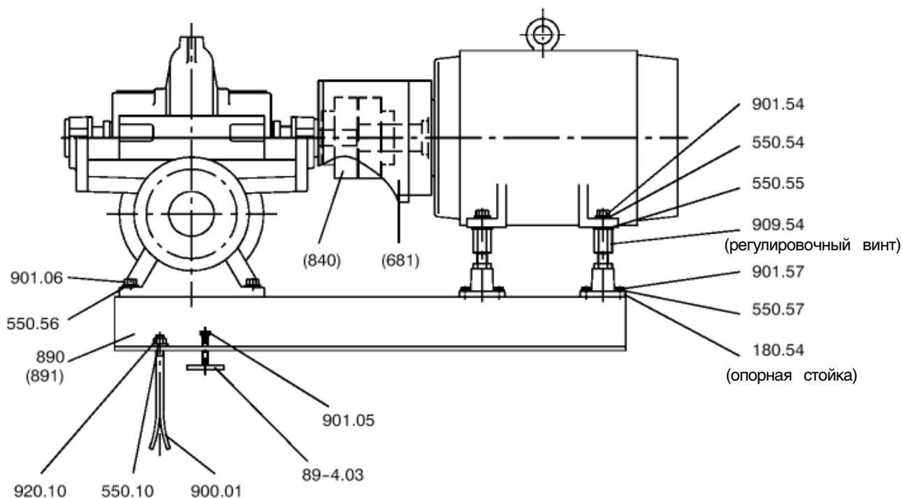
**Тип установки 3E - Выравнивание двигателя по уровню - Опорная рама с регулировочными подкладками / Регулировочные подкладочные пластины под опорными лапами двигателя**
