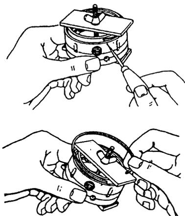
2 После этого последовательное вынимают контактное кольцо (574/578), кольцевую прокладку круглого сечения (123), нажимное кольцо (583) и пружины (582/092).
