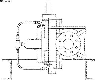
04 Трубопровод промывочной жидкости для торцового уплотнения. Трубопровод промывочной жидкости для подшипника Residur
