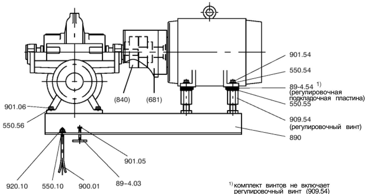
**Тип установки 3E - Регулирование двигателя по высоте - Фундаментная плита с регулировочным винтом и опорной стойкой**
