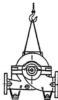
Рис. 1 Транспортировка насоса (Фигура 0)
