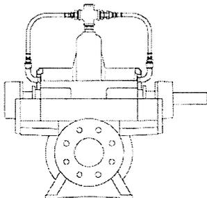
02 Трубопровод промывочной жидкости для торцового уплотнения
