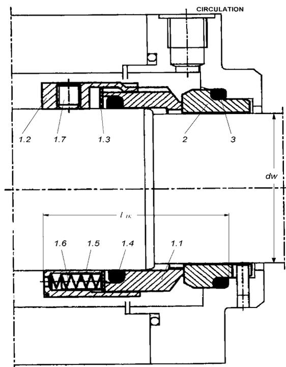
Рис. 1: Торцовое уплотнение - общий монтаж
