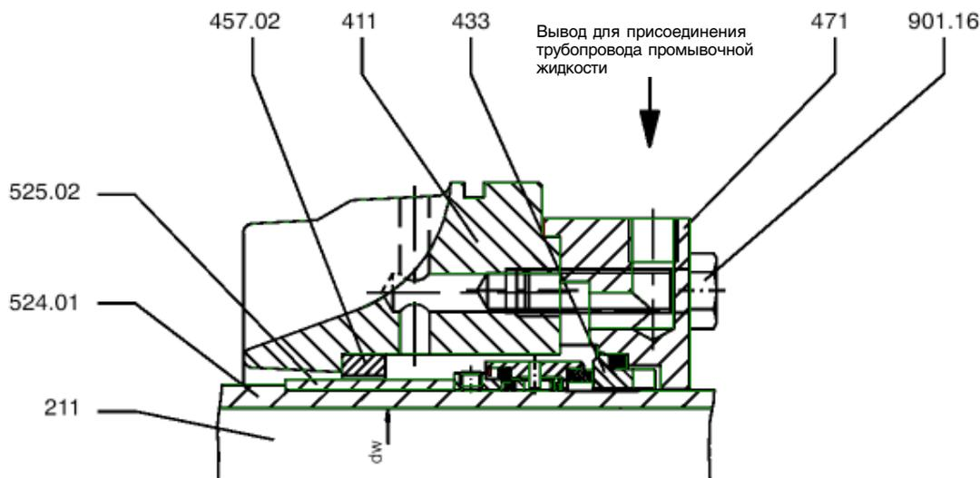
Разгруженное торцовое уплотнение (для рабочих давлений  $p \geq 16$  бар) по DIN 24960
