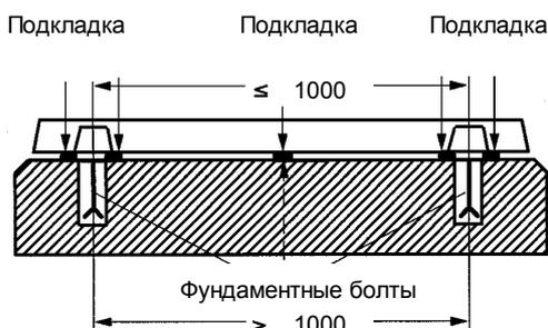
Рис.5: Размещение регулировочных подкладок
