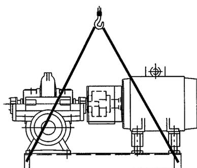
Рис. 4а: Транспортировка насосного агрегата целиком (горизонтальная установка - 3Е)
