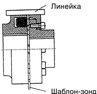
При использовании стрелочного индикатора точность центровки повышается.
