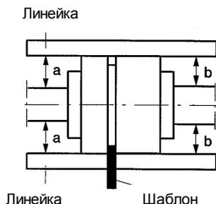
Bild.6: Центровка муфты шаблоном и линейкой
