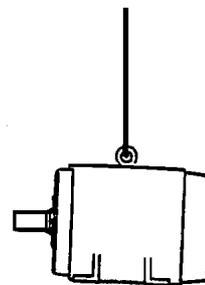
Рис. 2 Транспортировка электродвигателя
