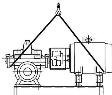
Рис. 4б: Транспортировка насосного агрегата целиком
