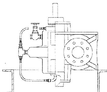
**Трубопровод затворной жидкости для сальниковго уплотнения**
