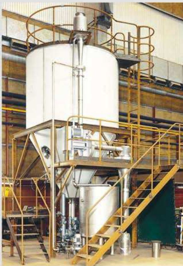
SG 132/40 - K 40 - SM 190 Q = 0,16 m 3 /h p = 25 bar P = 1,5 kW Medium: lead chromate 50 % DS
