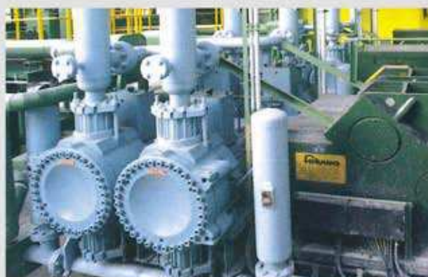
DG 250/250 - 2 K 180 - 4 SM 460 HD Q = 60 \text{ m}^3/\text{h} p = 77 \text{ bar} P = 220 \text{ kW} Среда: угольная пульпа 80% тв. включений
