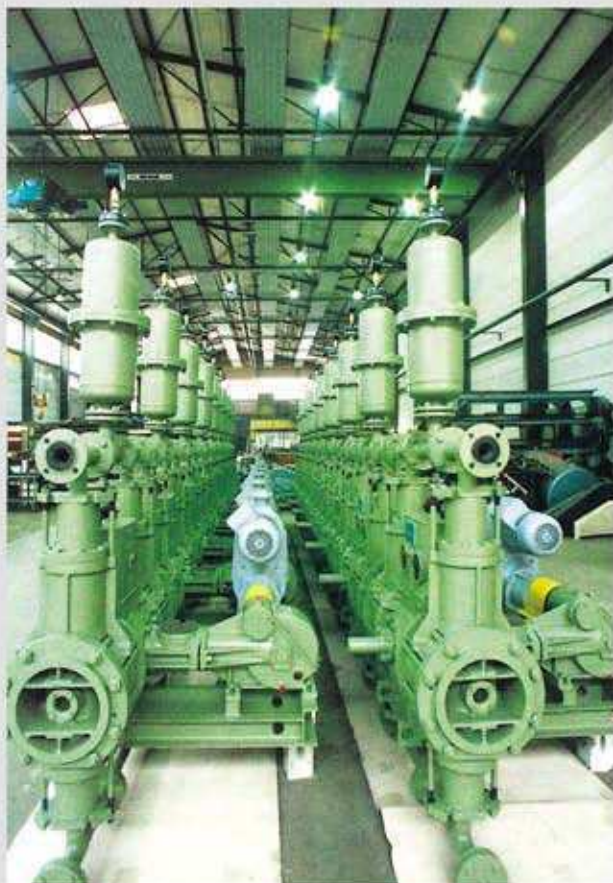
SG 25/70 - K 150 - SM 350/270 ZW Q = 2,4 - 7 \text{ m}^3/\text{h} p = 4 \text{ bar} P = 2,2 \text{ kW} Среда: вода и 21% веса кварц
