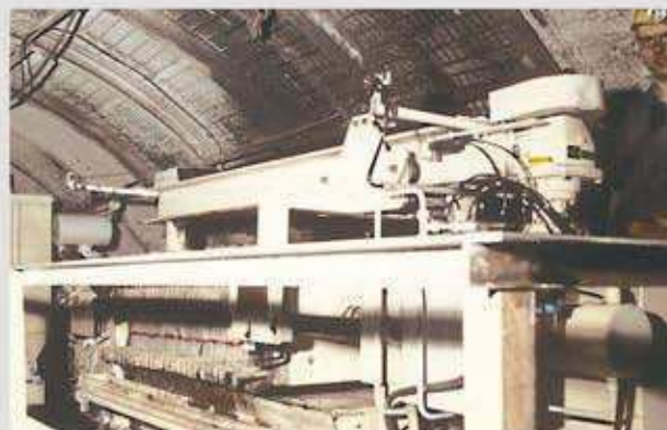
SG 25/70 - K 100 - SM 270 Q = 4 \text{ m}^3/\text{h} p = 15 \text{ bar} P = 5,9 \text{ kW} Среда: угольный шлам
