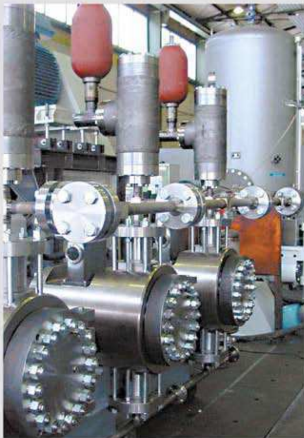
3 SG 180/200 - K 70 - 2 SM 270 HD Q = 3,5 \text{ m}^3/\text{h} p = 290 \text{ bar} P = 110 \text{ kW} Среда: шлам угольной пыли
