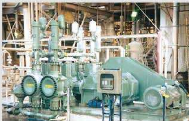
DG 180/200 - 2 K 220 - 4 SM 460 HD Q = 50 \text{ m}^3/\text{h} p = 56,5 \text{ bar} P = 132 \text{ kW} Среда: известковое молоко
