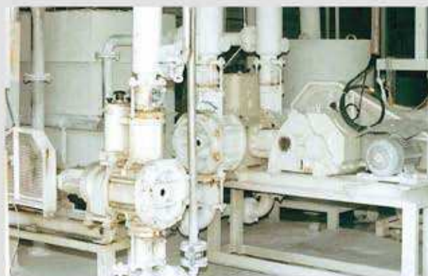
SG 25/70 - K 145 - SM 350/270 Q = 5 \text{ m}^3/\text{h} p = 8 \text{ bar} P = 4 \text{ kW} Среда: шлам каменной извести
