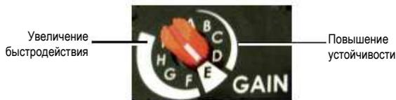
**Рис. 10: Поворотный переключатель GAIN (регулировка коэффициента усиления)**
