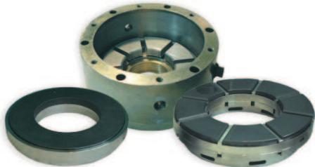
В основе конструкции подшипниковых узлов заложен принцип сохранения плоскопараллельного контакта, что обеспечивается подвижностью рабочих сегментов за счет упругих деформаций сегментного моноблока.
