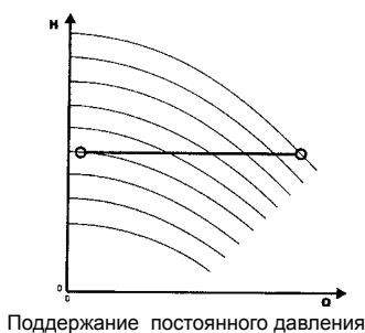
Поддержание постоянного давления
