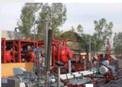
Перекачивание флюида во время опробования скважины, Абу Даби, ОАЭ
