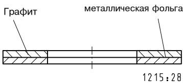
Рис. 7.4-1 Уплотнительное кольцо с металлической фольгой
