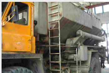
Взрывчатая смесь на основе нитрата аммония, 100 000 сП, насос 60IVA10
