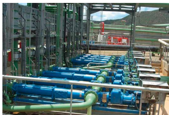
Минеральная пульпа – каждый насос 24015 обеспечивает нагнетание с расходом 130 м 3 /ч (добыча никеля)
