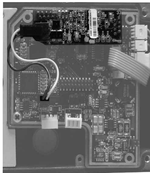
Рисунок 6: Плата аналогового выхода 4-20 мА
